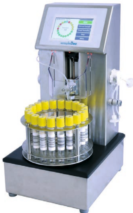
Endversion der Probeentnahme mit Schlauchsystem und Barcode gelabelten Probenröhrchen. Die Bedienung erfolgt über einen Touchscreen.
