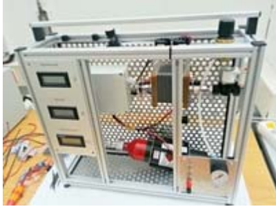
Autarke Energieversorgung mit PEM Brennstoffzellenheizgeräten
