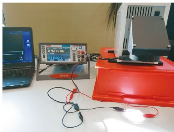
Abb. 3 Versuchsaufbau zur Messung von Strom-Spannungs-Kennlinien: Computer (links), Source Measure Unit (SMU, eine Kombination aus Netzteil und Multimeter) und Solarsimulator (rechts).
